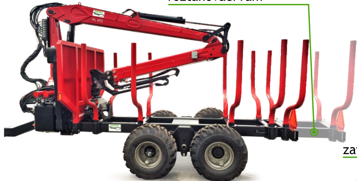
mechanicky/hydraulicky roztahovací rám
