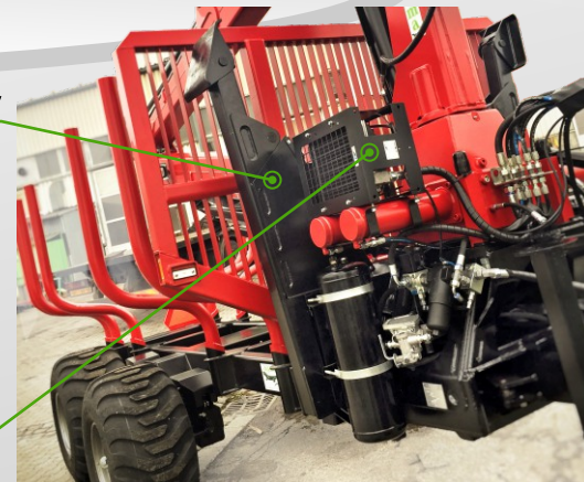
vlastní hydraulický okruh s ideálním průtokem a tlakem od 1000 ot./min. na motoru
