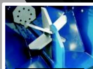
Robustní provedení uchycení štípacího nože
